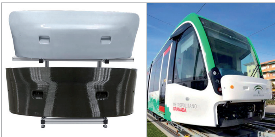
Рис. 2. Пример печати на Super Discovery 3D Printer компонентов для железнодорожного транспорта (проект компании CAF)
