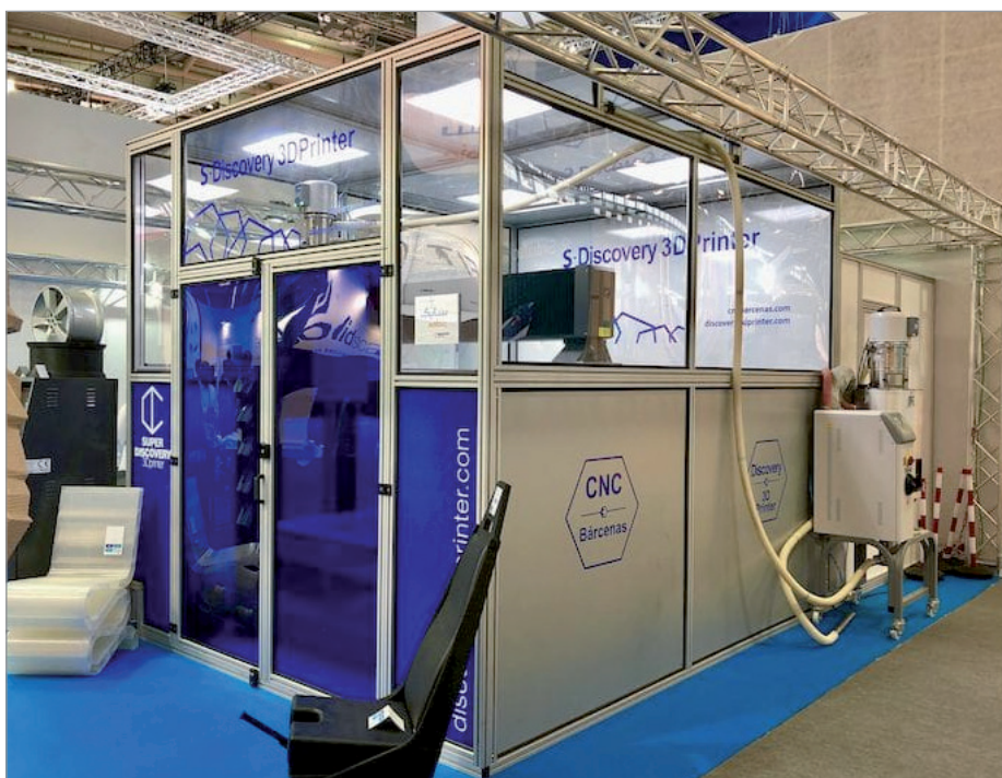
Рис. 1. Super Discovery 3D Printer – аддитивная установка с камерой построения 1300x2500x1000 мм / Фото fabaloo.com
