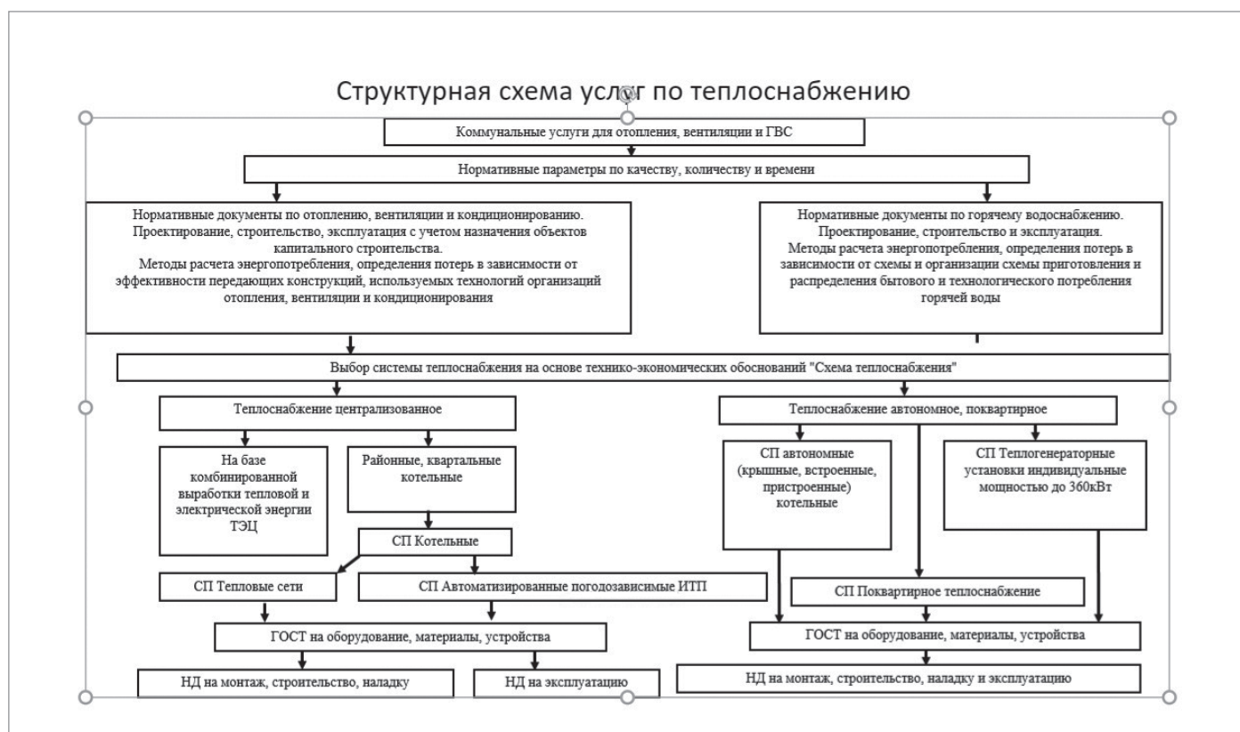
Рис. 1. Структурная схема нормативно-технических документов, регламентирующих услуги в области теплоснабжения
