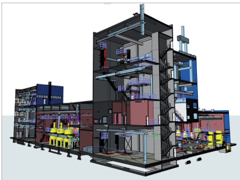
Рис. 20. Множество пересечений инженерных сетей между собой и со строительными конструкциями
