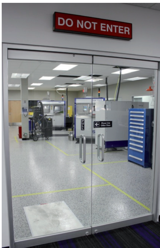
Обеспечение безопасности на входе: знаки и липкие коврики предотвращают загрязнение порошком за пределами рабочей зоны
