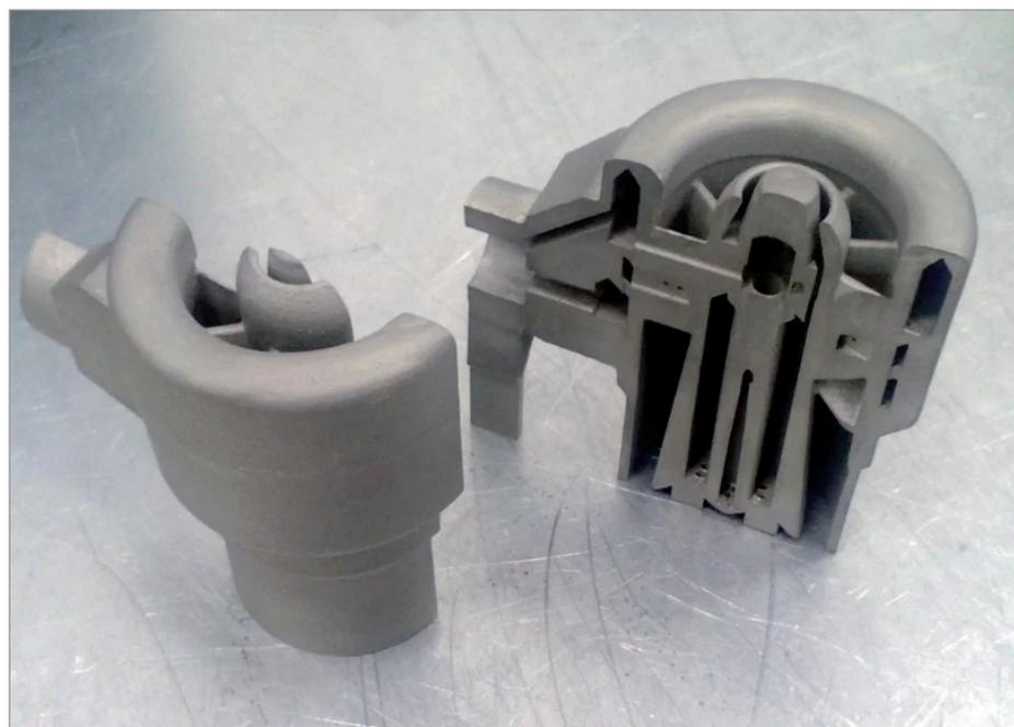
Горелочное устройство камеры сгорания / Фото [iQB Technologies](https://iqbtechnologies.com)
