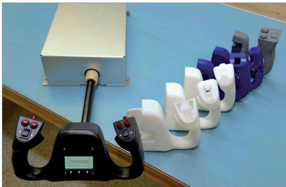
Разработка конструкции от первых набросков до готового штурвала оптимальной формы со встроенной электроникой. Проектирование было реализовано в системе Solid Edge, а опытные образцы изготавливались на 3D-принтере. Фото М. Фрутига
