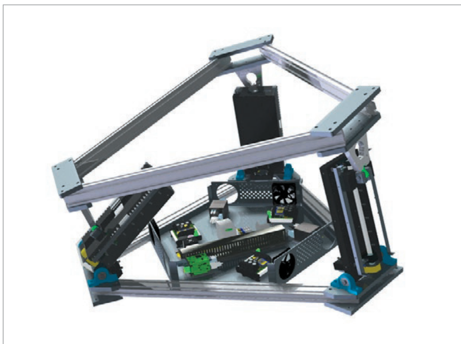
Фотореалистичное изображение, созданное в системе Solid Edge. Подвижная платформа пилотажного тренажера содержит мощные и точные механические приводы, а также сложные системы управления
