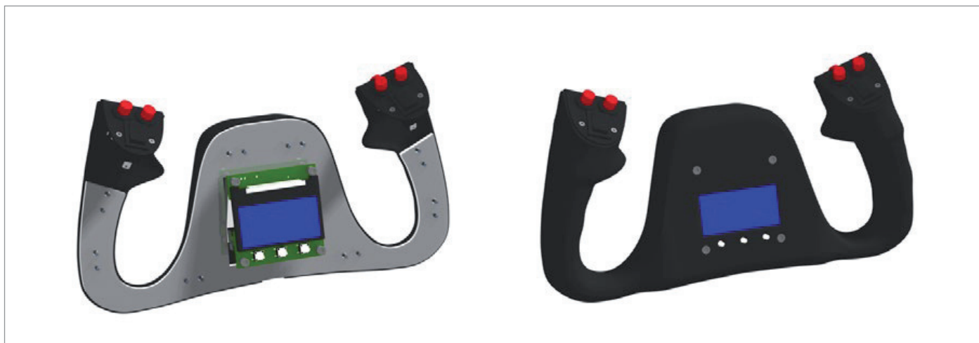
3D-изображение внутренней конструкции штурвала с дисплеем управления автопилотом и ЖК-панелью радиостанции
