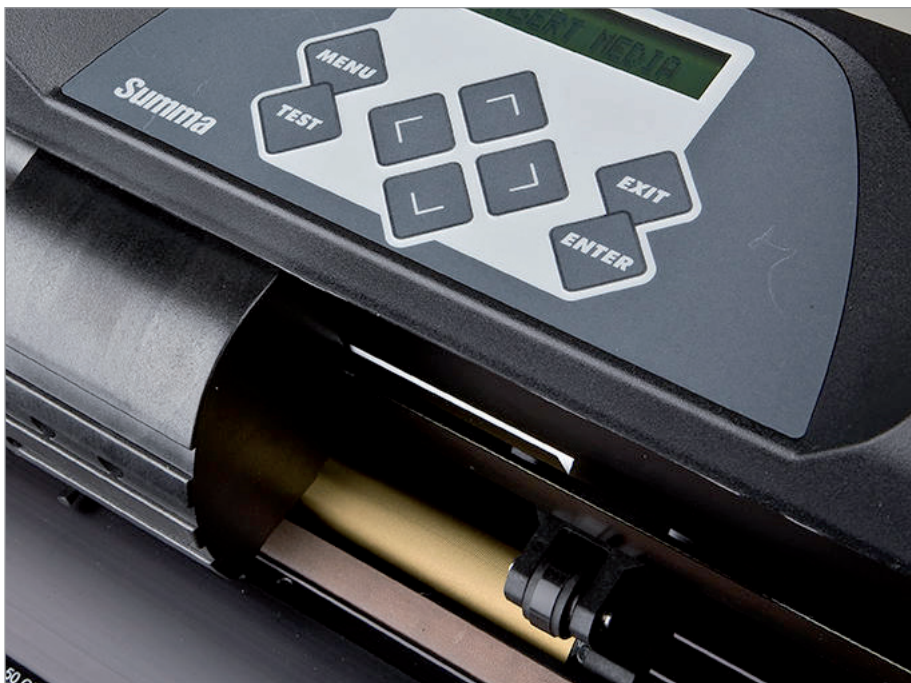
Рис. 4. Механизм подачи материала
