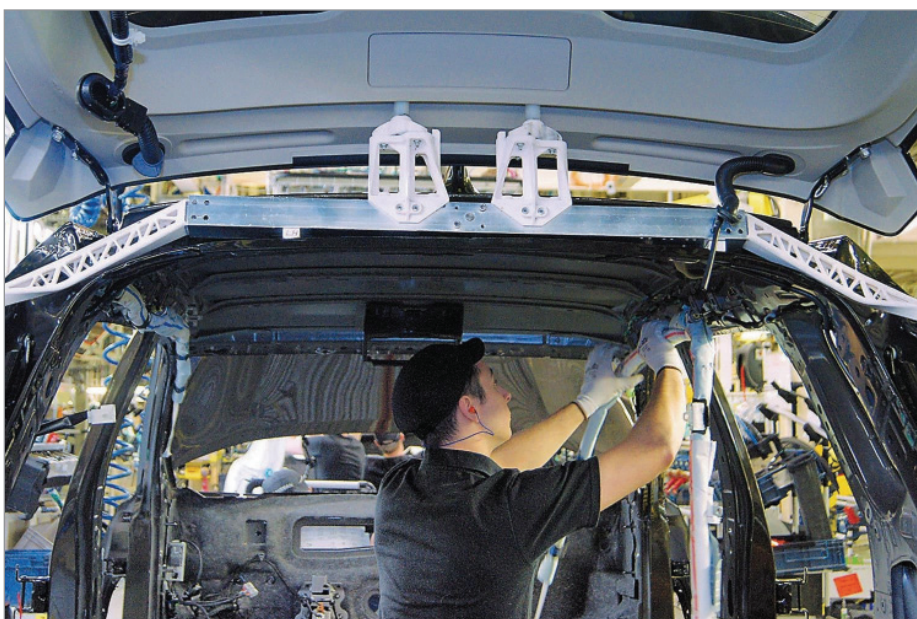
Завод Nissan в Санкт-Петербурге: изготовленные на 3D-принтере детали (белые на фото) используются для фиксации крышки багажника. Фото: "Ведомости" / Nissan
