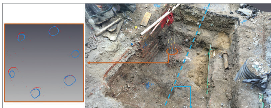
Горизонтальный разрез арматурных стержней, показывающий точное сравнение фотограмметрии с наземным лазерным сканированием (TLS): синие кружки обозначают фотограмметрию, а красные – TLS. Максимальное отклонение составляет 6-10 миллиметров
