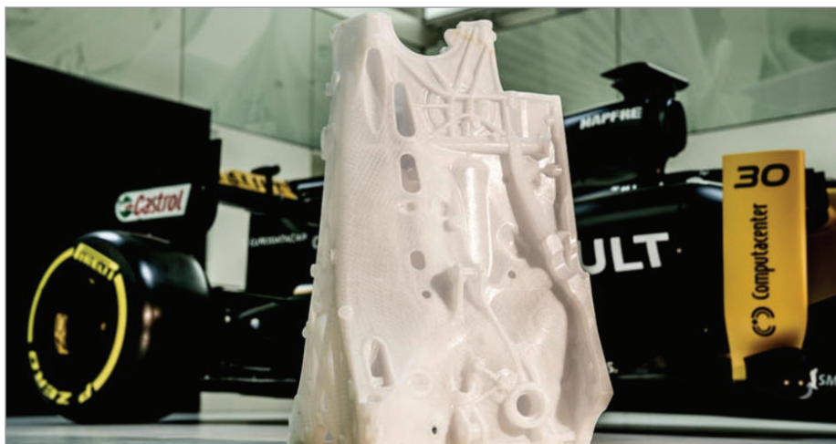
Напечатанные на 3D-принтере выжигаемые литейные модели позволяют Renault Formula One быстро изготавливать крупные металлические детали большой сложности
