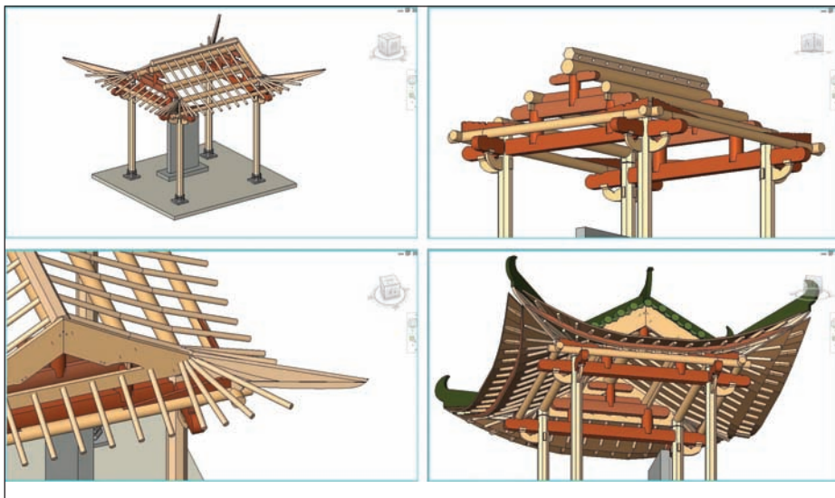
Моделирование системы доугун и других элементов конструкции
