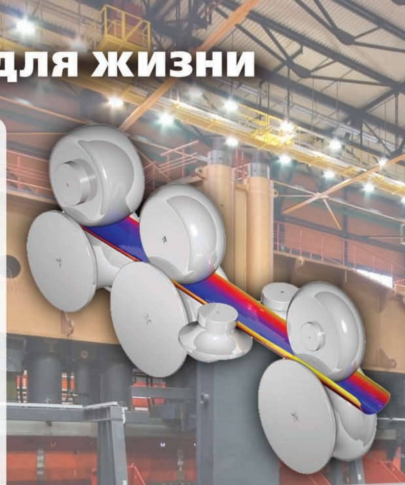
Процесс формообразования трубной заготовки
