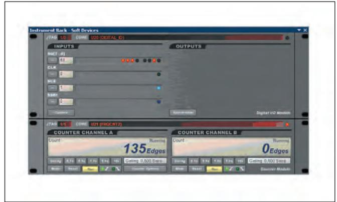
Рис. 10. Панель виртуальных инструментов отладки. В панели виртуального цифрового модуля световыми индикаторами отображаются логические уровни сигналов на внутренних узлах ПЛИС и выходных контактах. Одновременно в левой части поля *SQ[7..0]* выводится шестнадцатеричное число, показывающее состояние разрядов регистра
