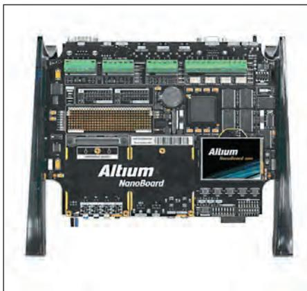
Рис. 1. Отладочный стенд NanoBoard 3000
