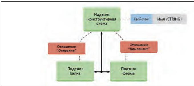
Рис. 4. Пример структуры модели данных, выраженной в языке EXPRESS
