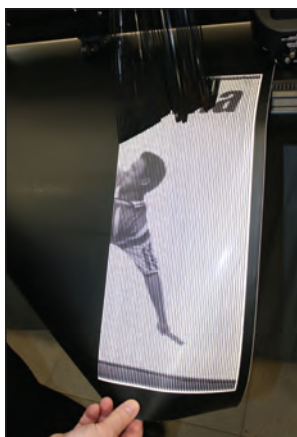
Фотоизображение переведено в модулированные полосы («векторизация» Photo Cut)
