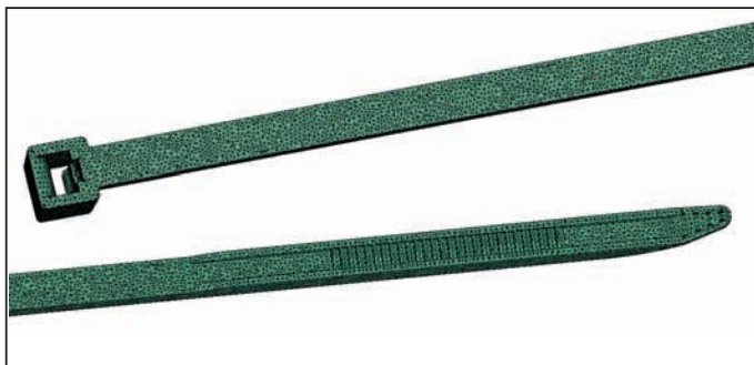
Рис. 1. Конечно-элементная модель детали "Хомутик" (фрагменты)
