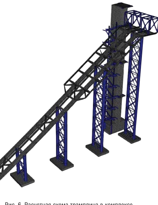
Рис. 6. Расчетная схема трамплина в комплексе SCAD
