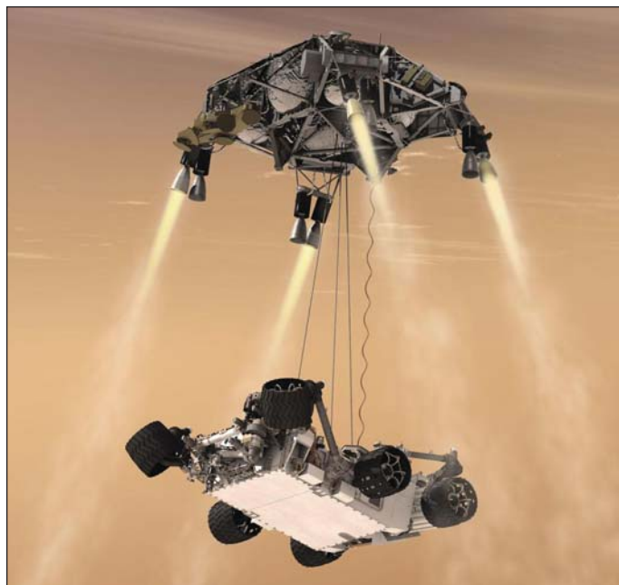
Рис. 2. Спуск марсохода при помощи летающей платформы Sky Crane
