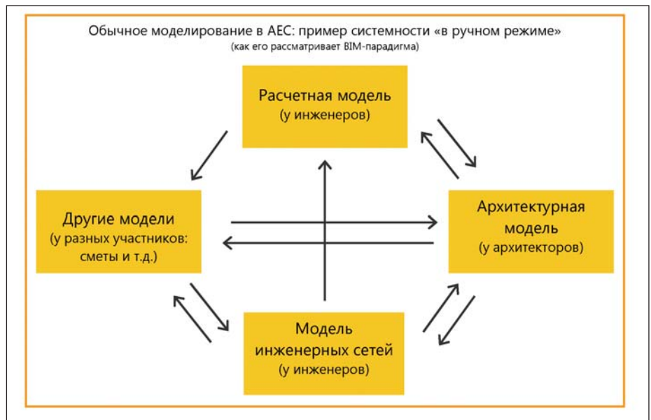
Рис. 1. Классическая схема моделей в рабочем процессе и обмена данными между ними
