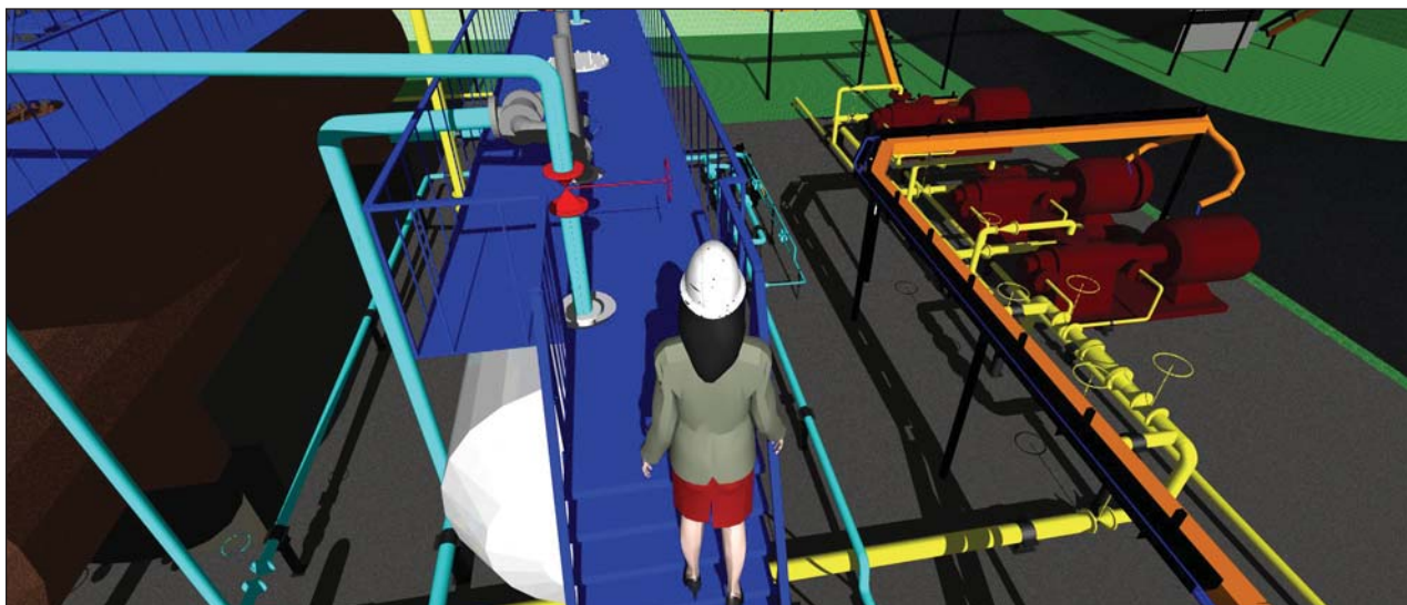
Рис. 6. Проверка модели средствами ПО Autodesk Navisworks Manage
