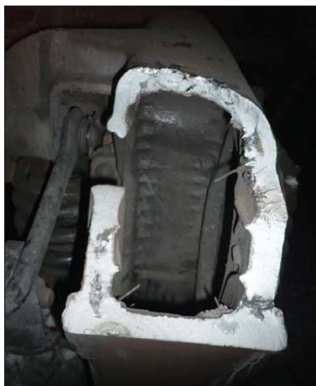
Рис. 3. Следы ремонта сваркой на верхнем поясе длиной 70 мм
