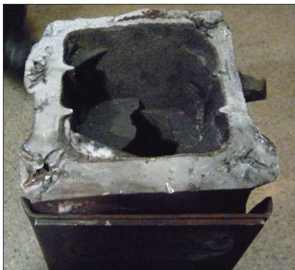
Рис. 2. Усадочные раковины в сечении буксового проема (R55)
