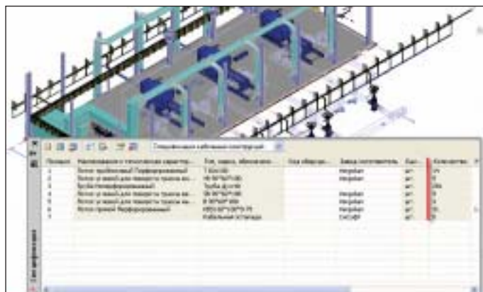
Рис. 5. Заказная спецификация на кабельные конструкции
