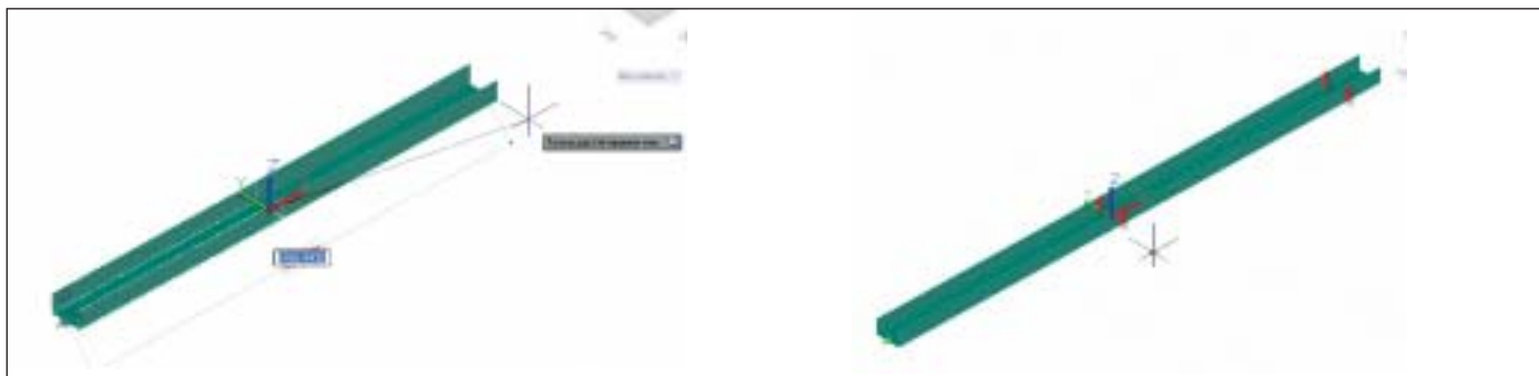
Рис. 3. Параметрические кабельные конструкции
