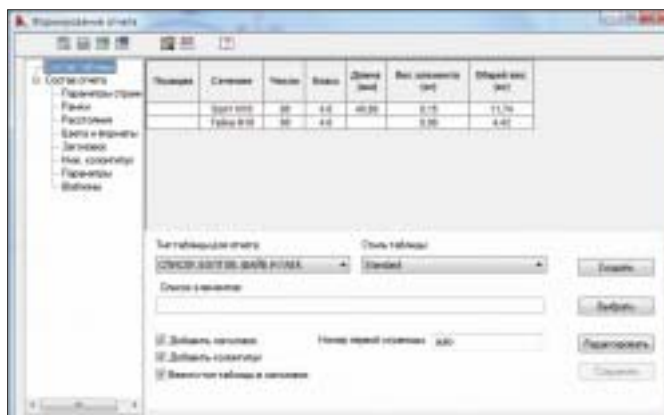
Рис. 24. ASD 2012. Формирование спецификации на болты, гайки и шайбы
