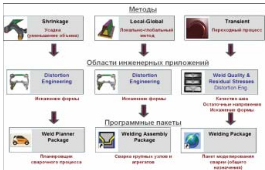
Рис. 1. Структура комплекса для моделирования сварочных процессов
