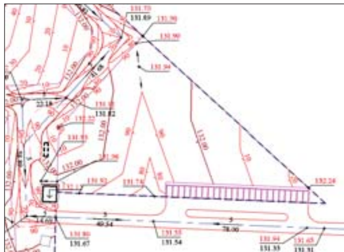
Рис. 5. Водоотвод с восточного участка
