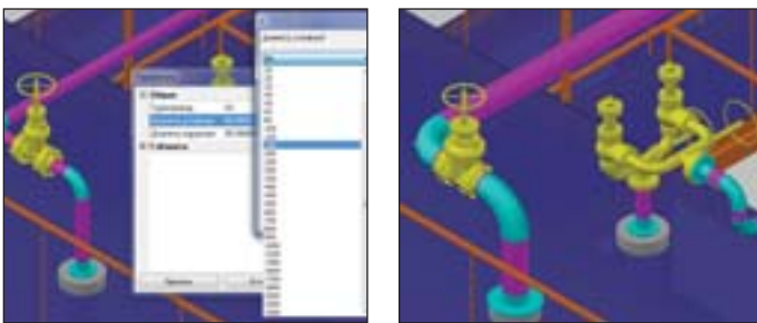
Редактирование свойств трубопровода. Изменение диаметра
