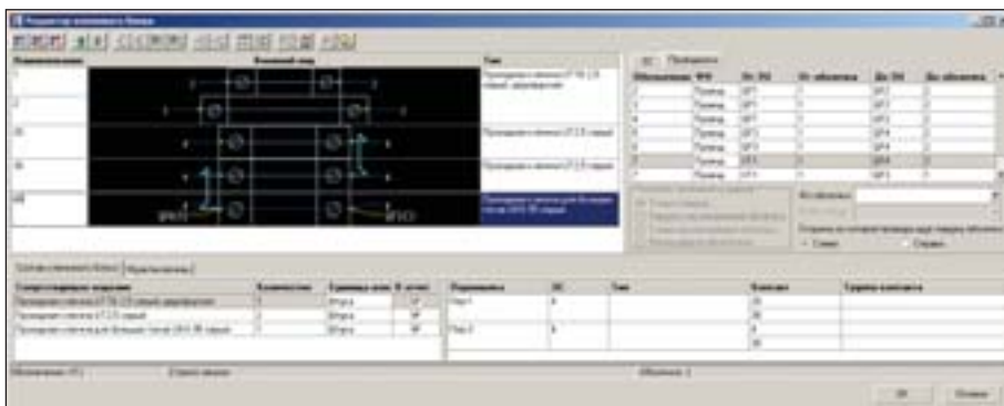
Окно редактора клеммного блока. Используются клеммы разных типов: первая клемма – двухъярусная, остальные обычные. Добавлены две перемычки для объединения соседних клемм. В нижней части окна показан состав клеммного блока. Электрические связи показаны синим цветом, провода – желтым
