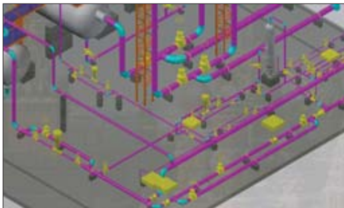
Система трубопроводов в Model Studio CS Трубопроводы
