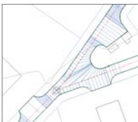
Рис. 6. Примыкание в коридоре дороги
