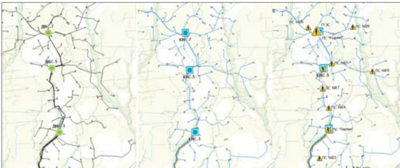
Рис. 1. Отображение систем нефтесбора, ППД и энергообеспечения в ГИС УДОМ
