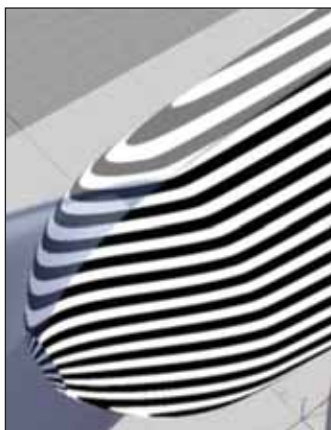
Рис. 2. Сглаженная поверхностная модель конусной части фена, сформированная кривой второго порядка
