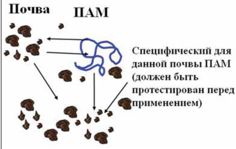
Схема действия и результат применения ПАМ
