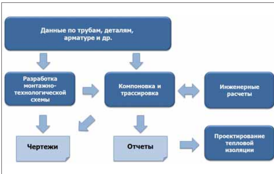
Рис. 1. Процесс монтажного проектирования
