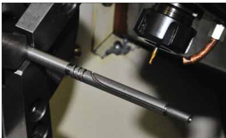
Обработка направляющей канавки копира
