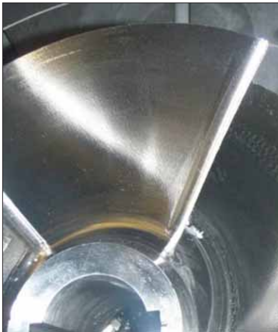
Рис. 8. Чистовая обработка лопатки
