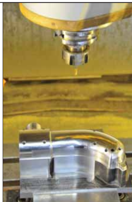
Чистовая обработка пуансона для пресс-формы
