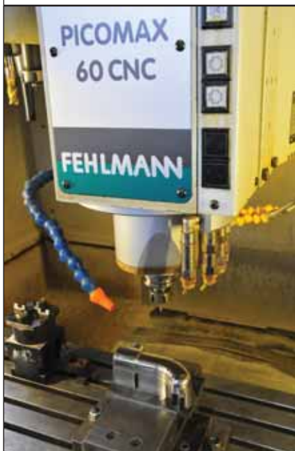
Чистовая обработка пуансона для пресс-формы
