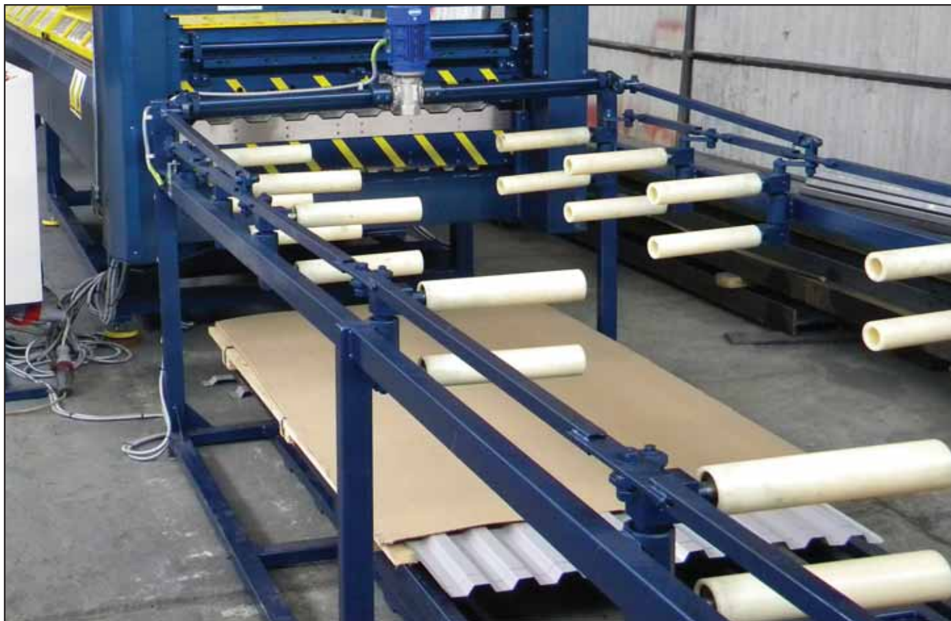
Рис. 5. Комбинированная линия по выпуску двух видов профилей
