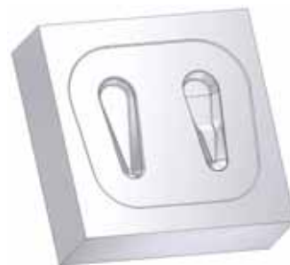
Обработка матрицы штампа для объемной штамповки
