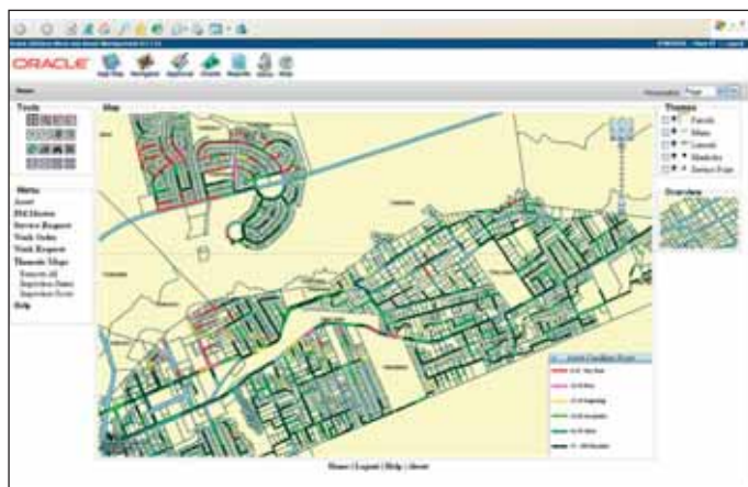
Рис. 6. Оценка состояния трубопроводов в выбранной области
