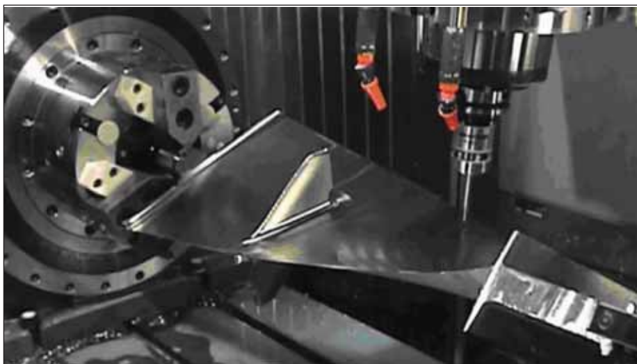
Рис. 4. Контроль обработанной лопатки непосредственно на станке
