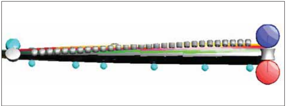
Рис. 13. "Опускающееся" формование в соответствии со значениями "минимальной продольной деформации"
