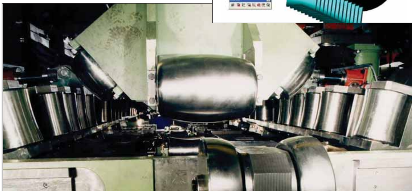
Рис. 8. Принцип системы формования в клетях (или линейного формования) с помощью COPRA (предоставлено SMS Meer (SMS Group))
