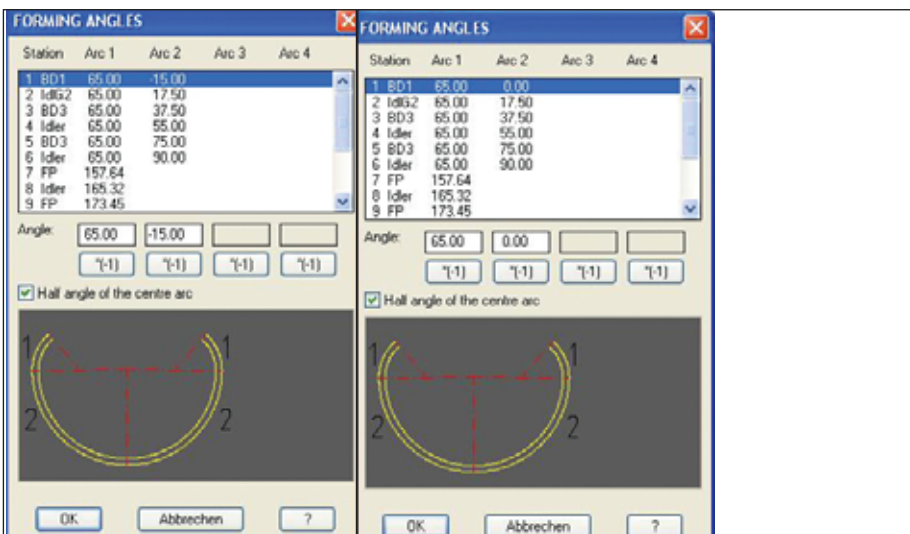
Рис. 7. Изменение внутренней дуги (номер 2) клетки № 1 с 15 градусов на 0 градусов дает другой метод формирования
