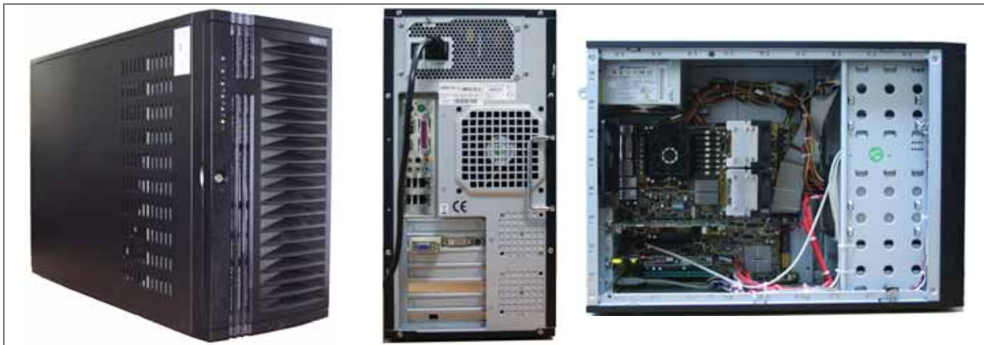
Рис. 4. Расчетная многоядерная (2x4) станция для проведения расчетов в системах инженерного анализа
