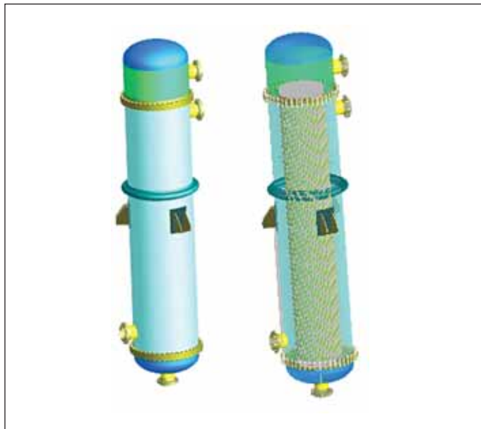
Рис. 4. Вертикальный аппарат с компенсатором
