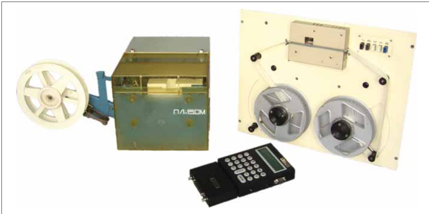
Рис. 4. Блок электроники ЭСЗУ-К с интерфейсной вставкой и фотосчитыватель CONSUL-337.601 с перфратором ПЛ-150М. Фотосчитыватель с перфратором весит 34 кг, потребляют мощность 340 Вт, а их цена составляет 40 978 руб. Блок электроники с интерфейсной вставкой весит 0,55 кг, потребляет 0,4 Вт и стоит 20 125 руб.
