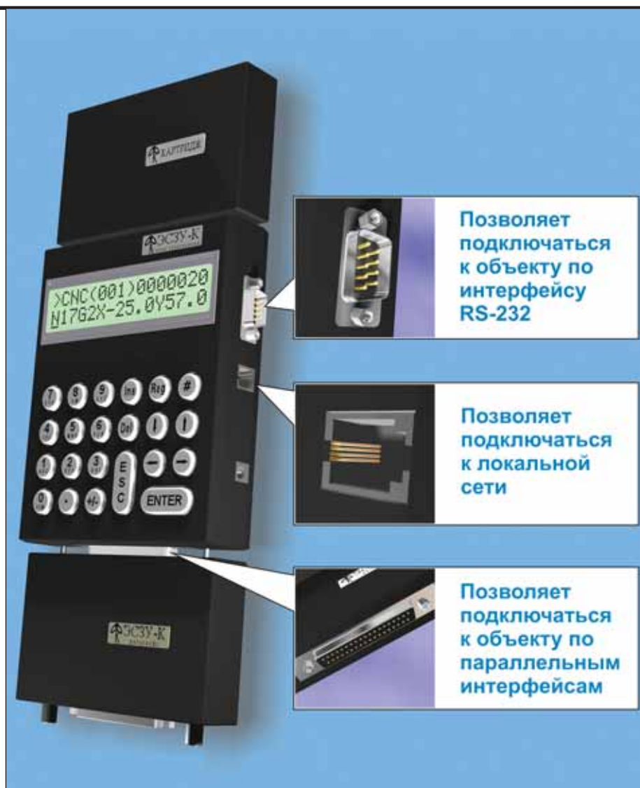
Рис. 1. Электронное считывающее и записывающее устройство модели "К" – ЭСЗУ-К
