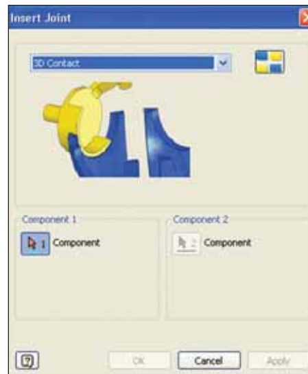
Рис. 4. Наложение связей (3D-контакт)
