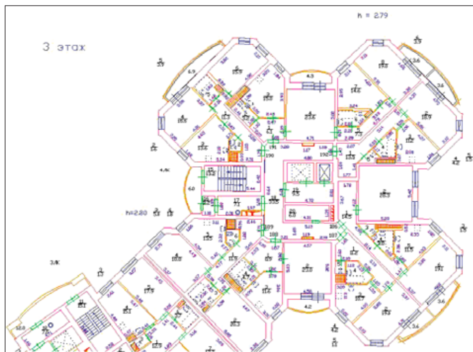
Фрагмент поэтажного плана, выполненный в программе PlanTracer
