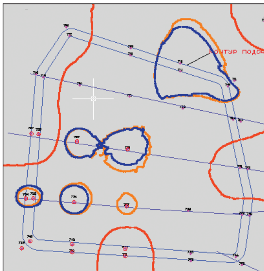
Рис. 4. Границы выхода грунтов на дно хранилища
