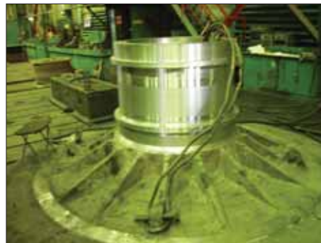
Рис. 6. Загрузочная крышка, изготовленная с применением измененной технологии
