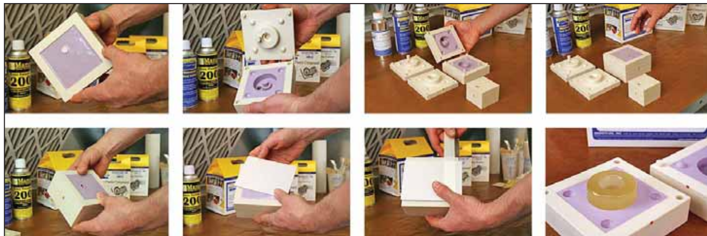
Извлечение отливки из эластичной формы
