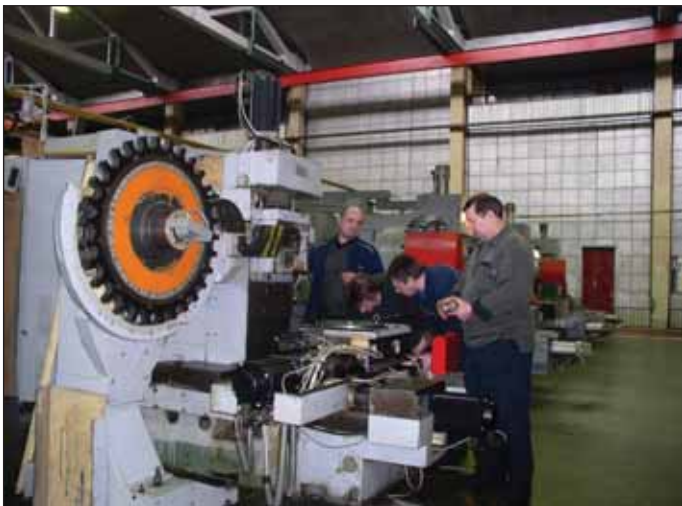
Рис. 7. Специалисты отдела главного механика ОАО ДНП проводят работы по комплексной модернизации обрабатывающего центра модели 2202ВМФ4 (производство завода "Жальгирис", г. Вильнюс, 1987 г.) с заменой УЧПУ 2С42-65 на NC200
