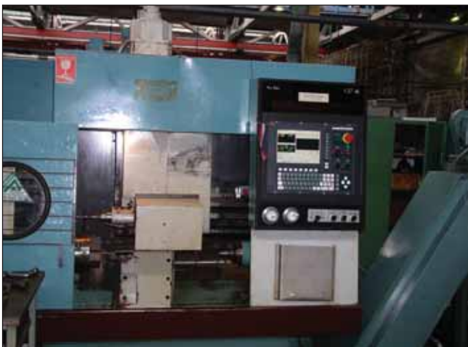
Рис. 11. Токарный станок с ЧПУ мод. SPT16NC (пр-во ЧССР, 1987 г.), на котором устаревшее УЧПУ NS660 было заменено на NC200 фирмы "Балт-систем" (ДНП, 2003 г.)
