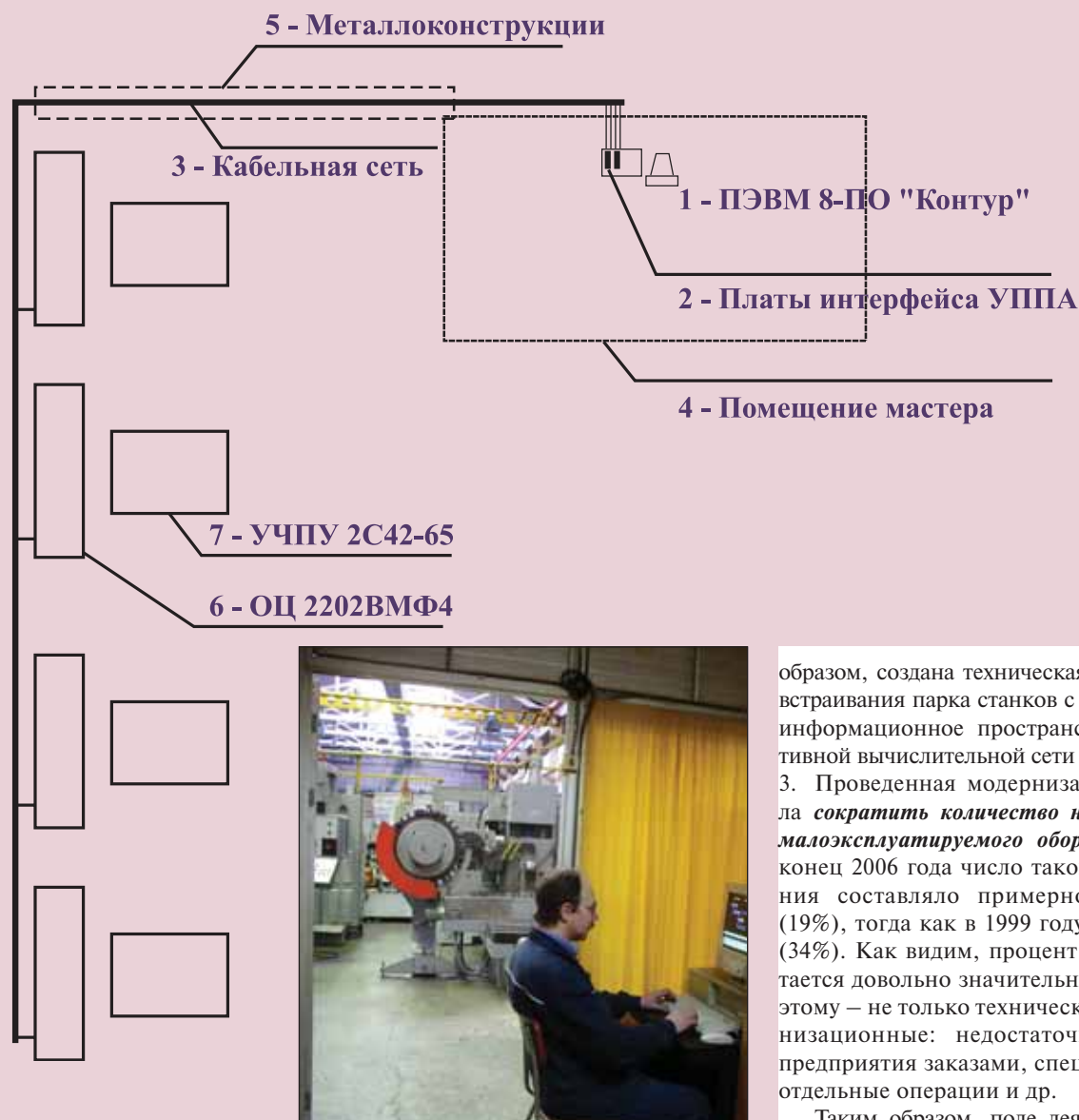
Рис. 22. Структура локальной сети из четырех обрабатывающих центров модели 2202ВМФ4 на базе ПЭВМ и комплекса УППА
