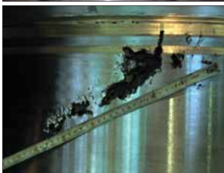
Рис. 3. Загрузочная крышка с усадочными дефектами
