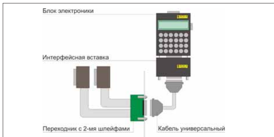
Рис. 1. Подключение ЭСЗУ-К с использованием переходника, универсального кабеля и интерфейсной вставки
