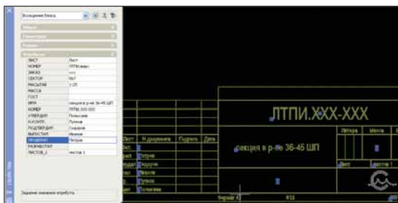
Рис. 2. Заполнение штампов и гранок средствами окна Свойства
