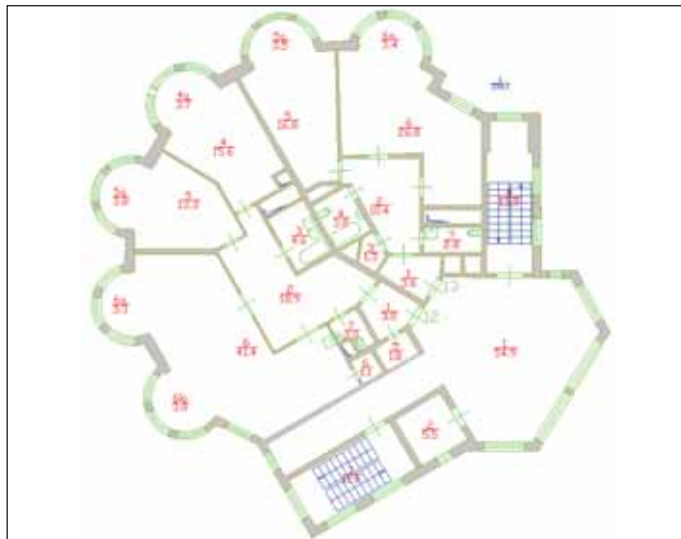
План после преобразования составных контуров в стены
