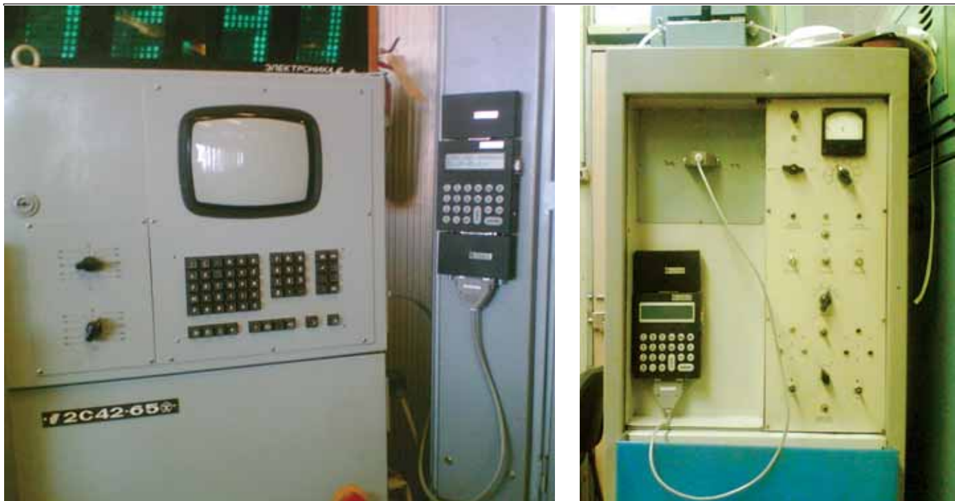
Рис. 1. Примеры "малой модернизации" систем УЧПУ 2C42-65 и 2P67
