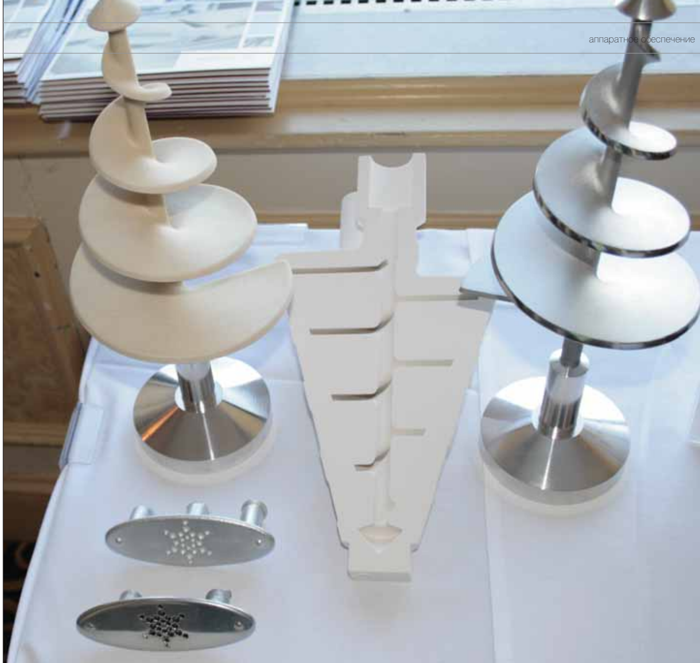
Рис. 6. Литейная форма из zr130 и готовая деталь
