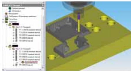
Трехмерные модели детали и специальной оснастки
