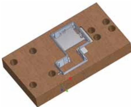
Трехмерные модели детали и специальной оснастки
