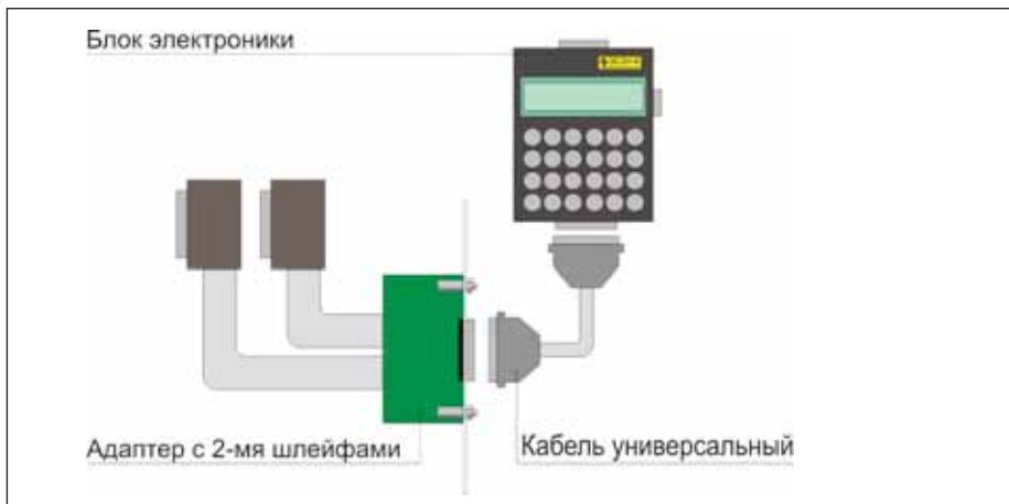
Рис. 2. Подключение ЭСЗУ-К с использованием адаптера и универсального кабеля
