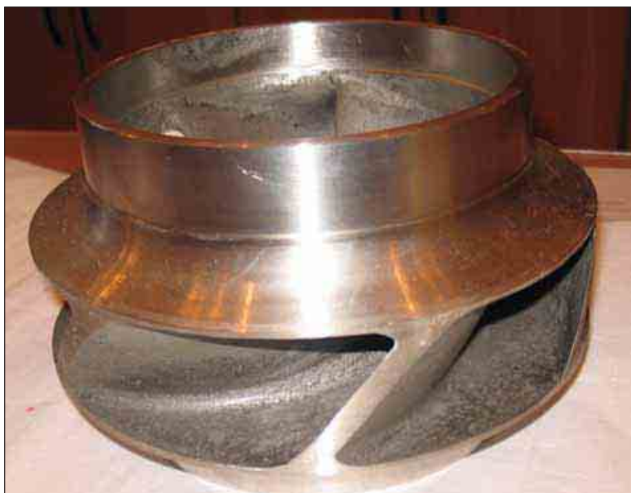
Рис. 9. Удалены прибыли и литники. Обработаны посадочные поверхности
