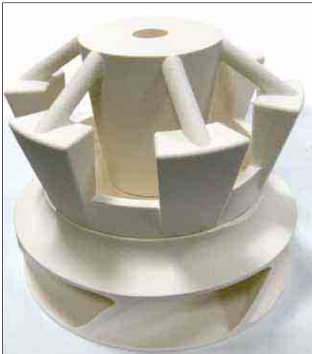
Рис. 3. После выращивания две части модели соединяются клеевым составом
