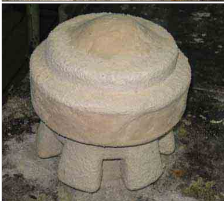
Рис. 4-5. Окончательный вид корки перед выжиганием модели
