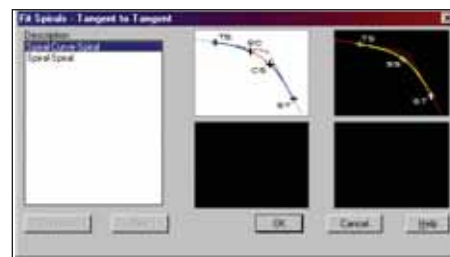
Рис. 3. Способы задания круговых и переходных кривых
