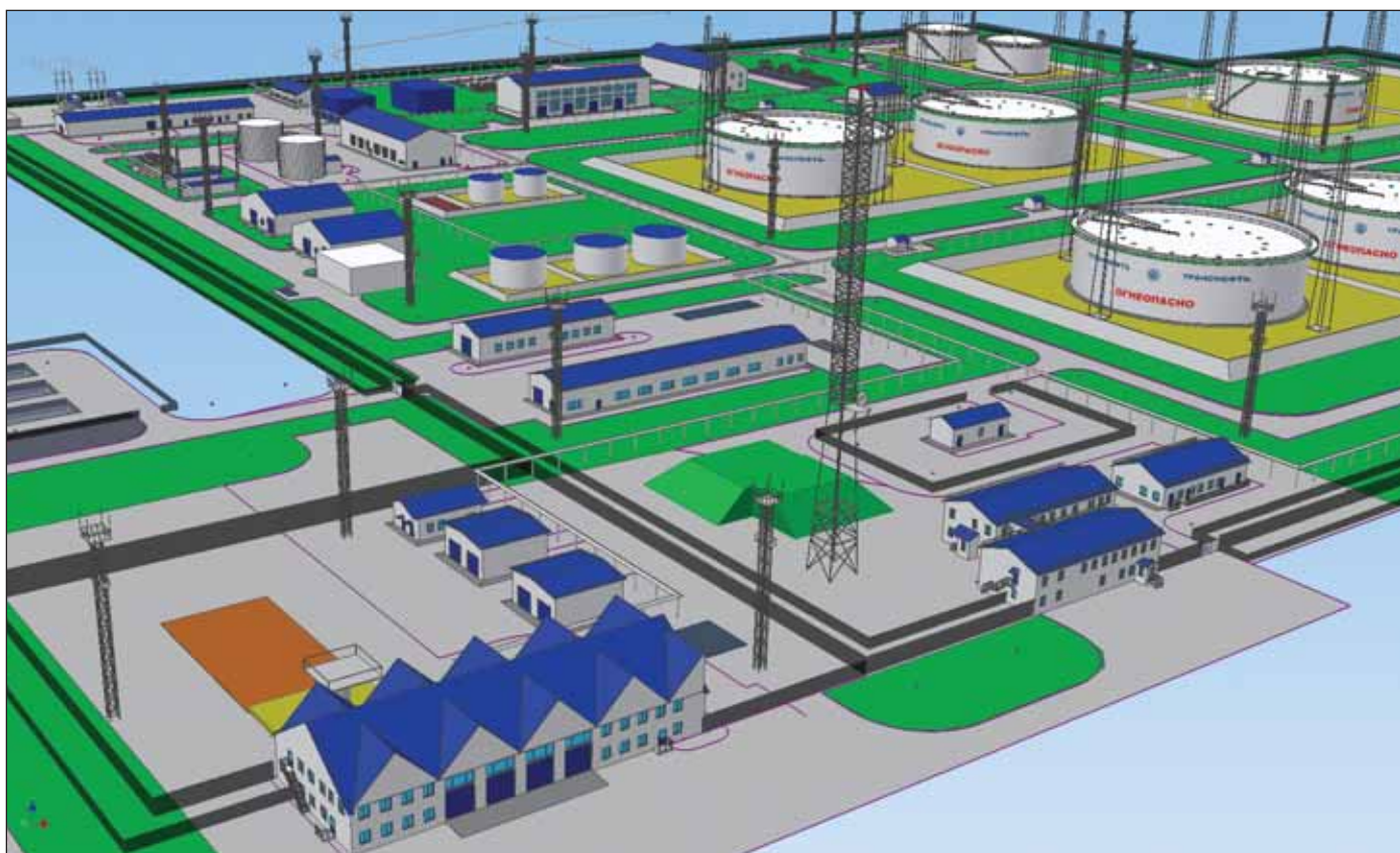
Рис. 8. Фрагмент варианта компоновки головной НПС с резервуарами в среде Autodesk Inventor (перспективная проекция)
