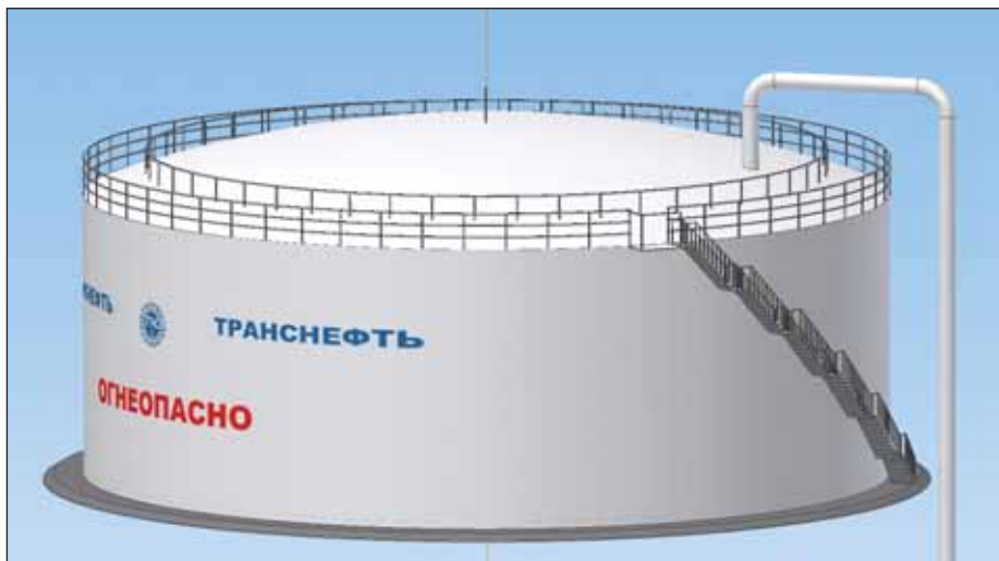
Рис. 3. Трехмерная параметрическая модель вертикального стального резервуара со стационарной крышей
