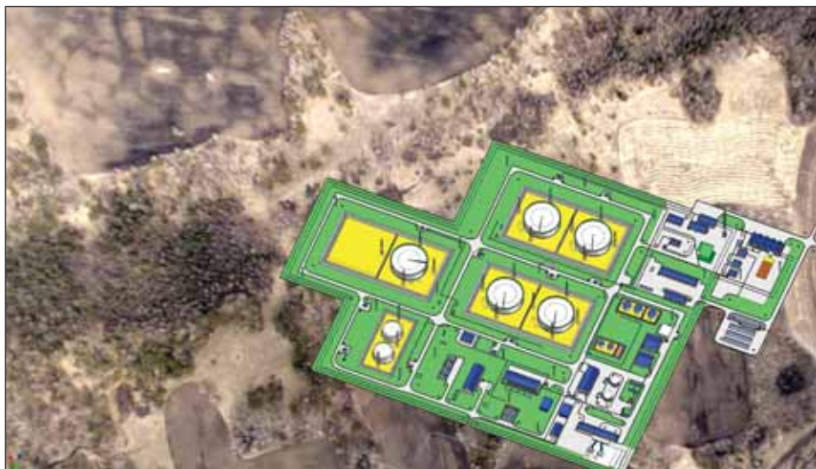
Рис. 11. Проекционное наложение варианта компоновки НПС с реальным рельефом местности
