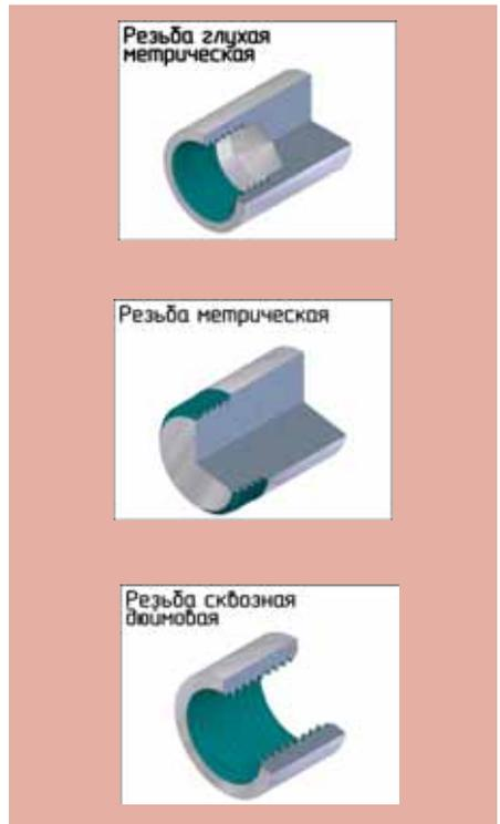
метчик – например, при работе на полуавтомате вертикальном резьбно-нарезном 2056. Для больших диаметров (до М36) применяются резцы (к примеру, на токарно-винторезном станке 16K20).
