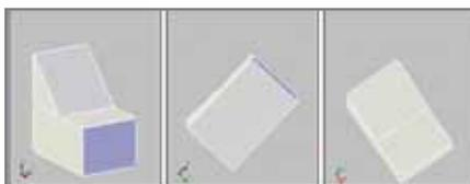
Рис. 1. Команда *3D Orbit* в режиме *Constrained Orbit*
