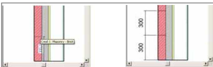
Рис. 4. Разбиваем слой *Masonry - Brick* сначала на две части, а потом на три
