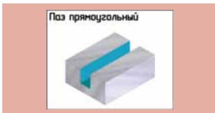
ком упрощенном случае ширина фрезы должна быть не больше и не меньше получаемого паза. Относительно станка 6Р83 выполнена настройка для получения пазов шириной 20, 22, 25, 28, 32, 36 и 40 мм.
