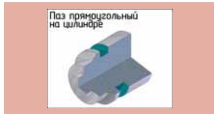
часть резца, обрабатывающего паз на цилиндре, должна быть равна ширине паза. Например, на токарно-винторезном станке 16К20 можно получить пазы шириной 3, 4, 5, 6, 8, 10 и 12 мм.
