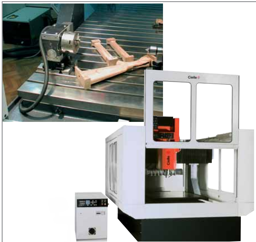
Станок GAMMA 100/180. Производство деталей из древесины
