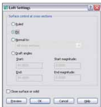
Рис. 24. Установка параметров инструмента Loft
