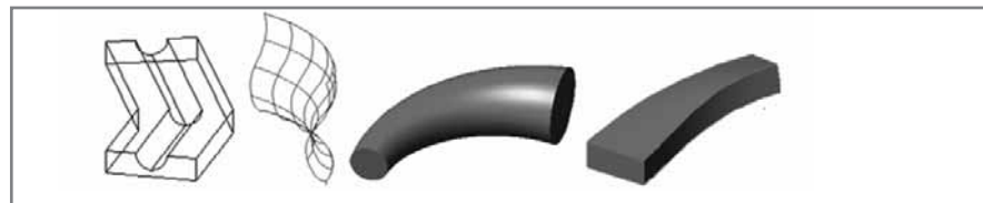
Рис. 22. Тела и поверхности выдавливания ( Sweep )
