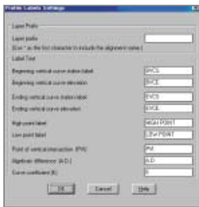
Рис. 14. Назначение обозначений элементов продольного профиля
