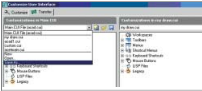
Рис. 43. Действия по созданию и сохранению частичных файлов производятся в закладке Transfer диалогового окна Customize User Interface . Показано сохранение основного файла acad.cui под другим именем
