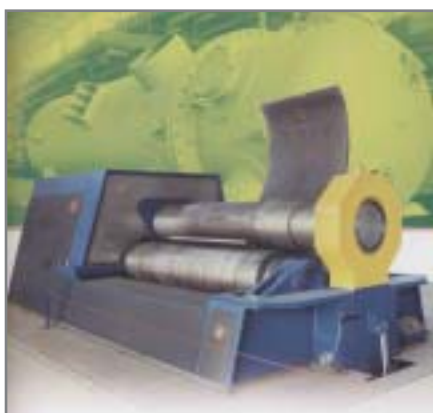
Уникальный гидравлический 4-валковый листогибочный станок MG 3110
