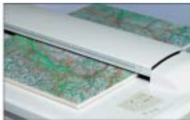
Ч/б и цветное сканирование (от 25 до 54"), толщина оригиналов – от 0,1 до 15 мм
