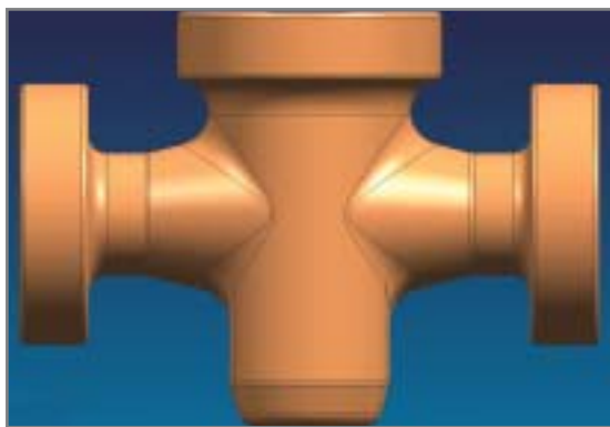
Рис. 1а. Вертикальное расположение отливки
