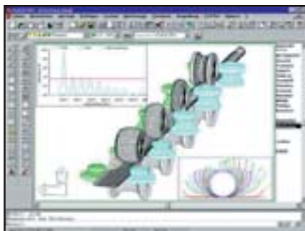
↑ COPRA моделирует процесс проката на мониторе компьютера
