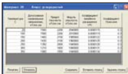
Рис. 5. Физико-механические характеристики стали 20
