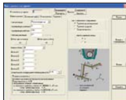
Рис. 4. Расчет вертикальной врезки (бесканальная прокладка)
