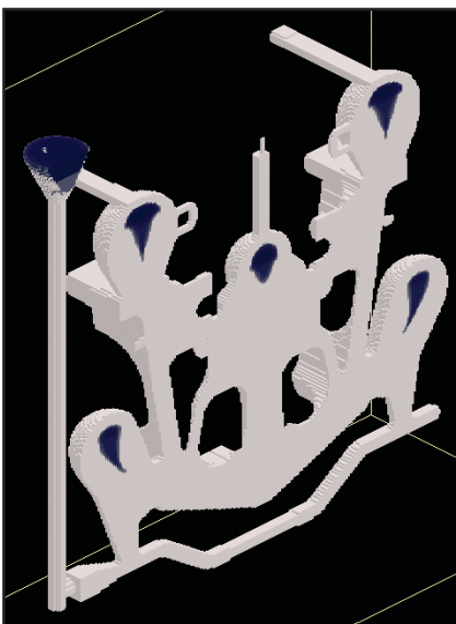
Рис. 15. Распределение дефектов усадочного происхождения после кристаллизации отливки
