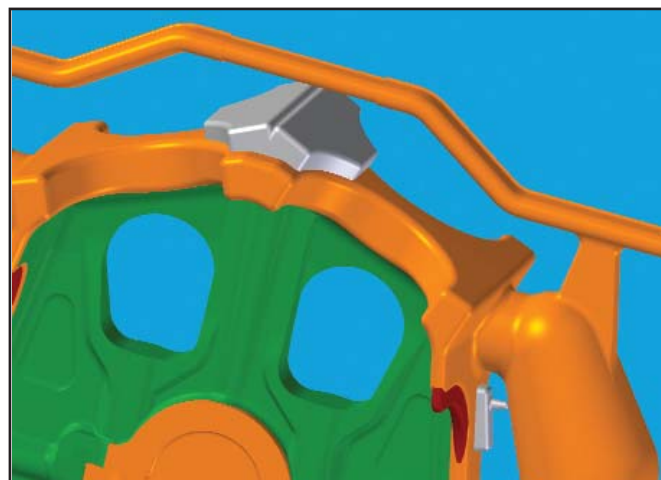
▲ Рис. 4. Расположение холодильников относительно литниковой системы
