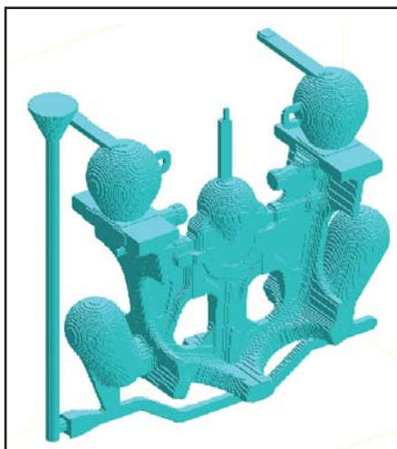
Рис. 7. Отливка с литниково-питательной системой
