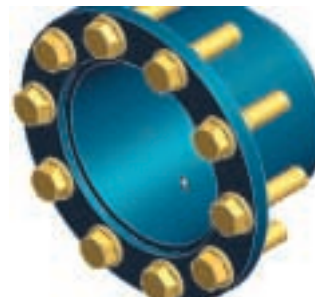
Количество крепежных соединений обновилось автоматически
