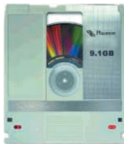
В хранилище, организованном в виде библиотеки, на один привод приходится несколько носителей (На иллюстрации — MO-носитель.)
