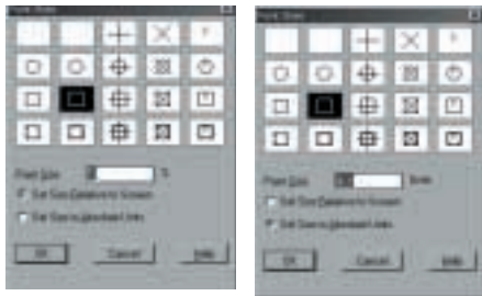
Рис. 8. Настройка относительного и абсолютного размеров символа точки
