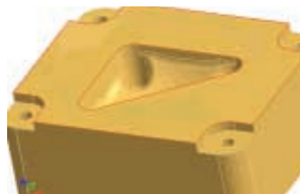
Результат вычитания одной детали из другой
