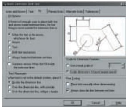
Рис. 9. Настройка автоматически масштабируемого размерного стиля
