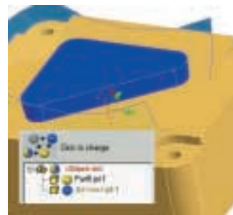
Окно задания параметров булевых операций (показано вычитание компонента Деталь1.ipt:1 из детали Part8.ipt:1)
