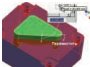
Изменение расстояния между торцами деталей
