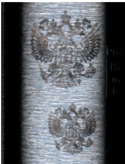
Примеры гравировки на стальном цилиндре диаметром 20 мм
