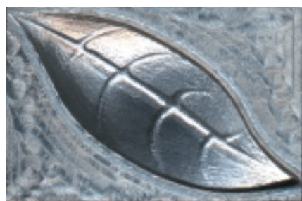
Пример фрезеровки стальной заготовки в масштабе 2:1
