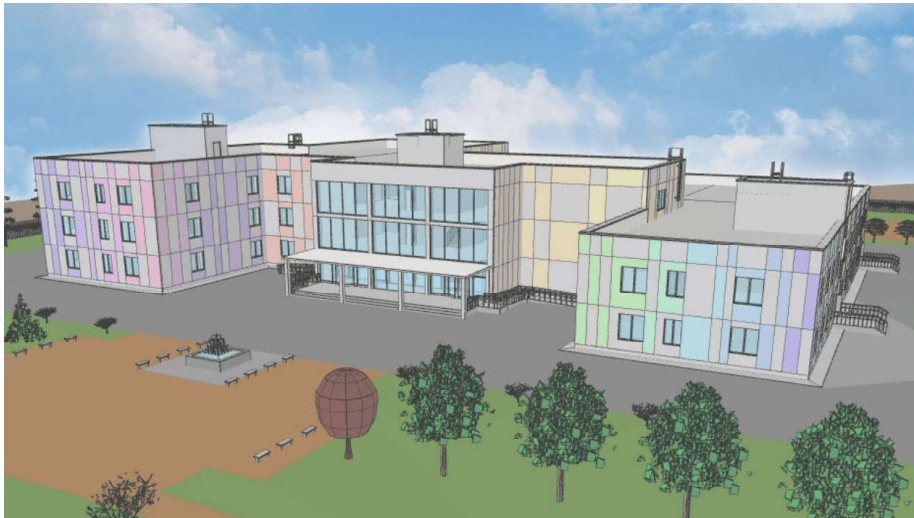
Рис. 15. Трехмерная информационная модель здания культурного центра, разработанная в программном комплексе Model Studio CS и CADLib Модель и Архив
