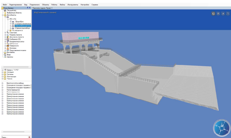
Рис. 17. Модель конструкций водосбора и галереи подъемных механизмов в CADLib Модель и Архив
