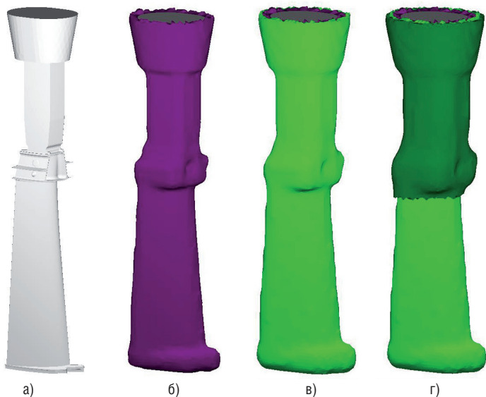
Рис. 4. Создание оболочек формы и теплоизоляции для моделирования ЛВМ:
