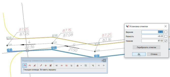
Рис. 35. Вставка новых вершин в процессе редактирования структурной линии разрыва
