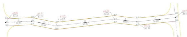
Рис. 33. Пример построения структурных линий разрыва из стандартной структурной линии
