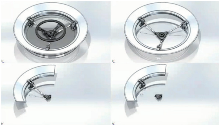
Рис. 2. Упрощение расчетной модели. Удаление несущественных деталей, применение \frac{1}{3} циклической модели, удаление тяги и замена ее на новый соединитель
