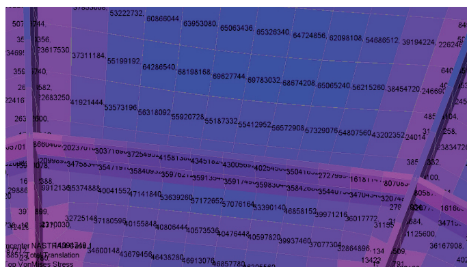
Рис. 11. Напряжения в элементах крышки
