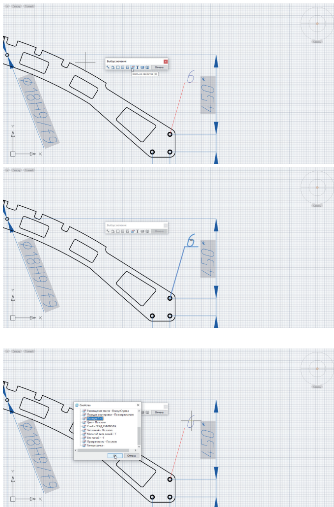
Рис. 31. Создание ссылки на позицию в технических требованиях с помощью функции Взять с чертежа
