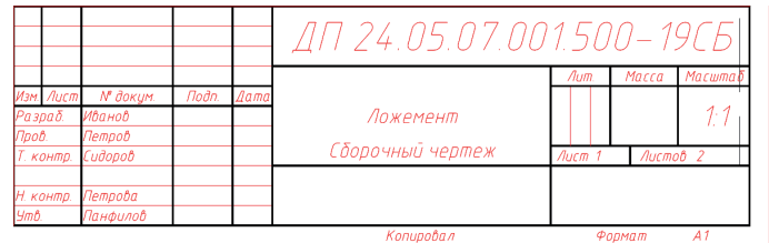
Рис. 20. Оформленный штамп чертежа
