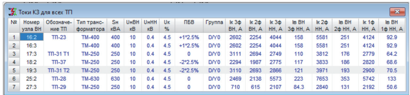
Рис. 5. Расчет токов КЗ на стороне ВН и на стороне НН для всех ТП модели
