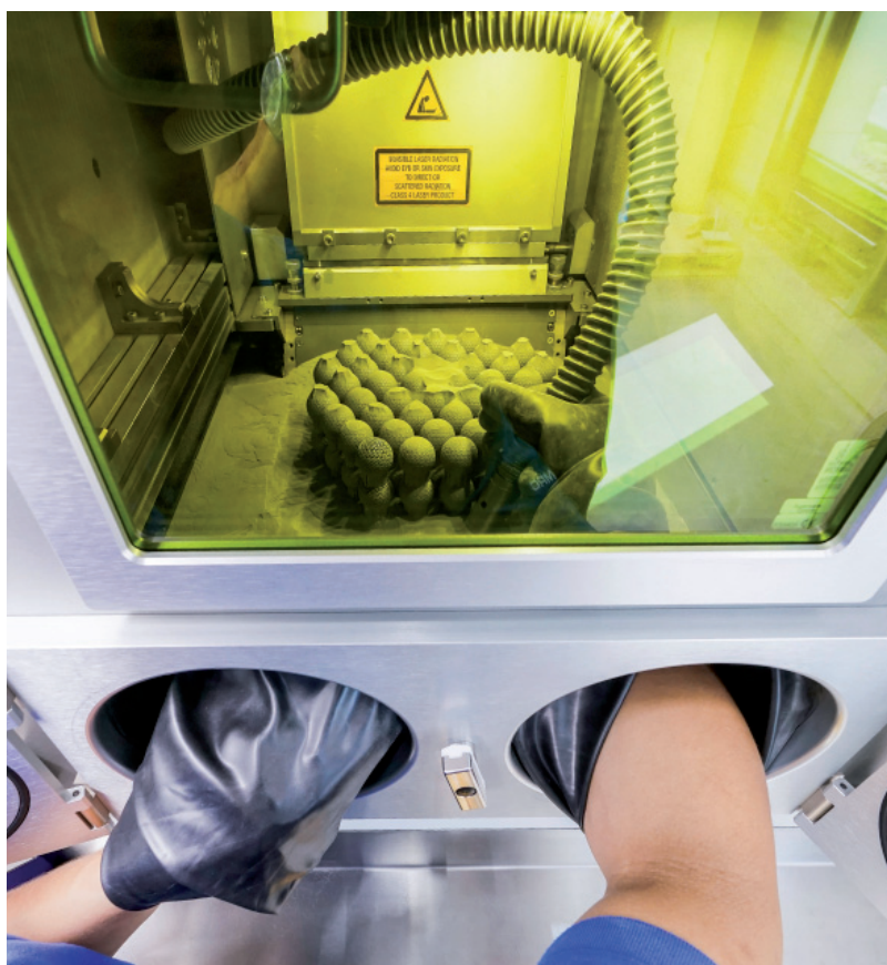
Удаление порошка из SLM-машины
