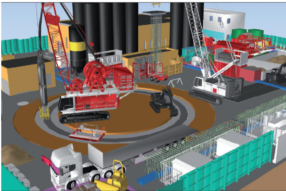
Используя SYNCHRO 4D, предприятие CVB JV создало более 30 4D-моделей для анализа технологичности и оптимизации планирования строительства
